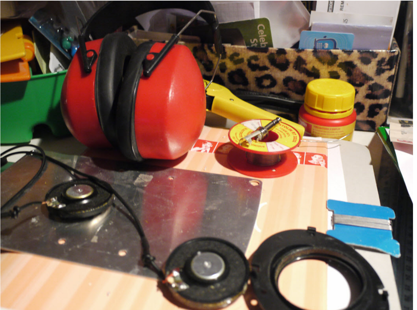
Marquage au fer à souder des passages cables HP
